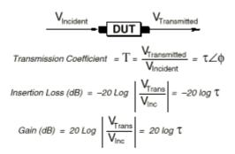
Fig,4: Transmission parameters
